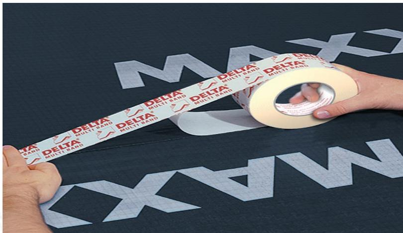
**Description:** ruban collant pour le collage des recouvrements et la réparation des écrans DELTA®. Collage sur la face externe des écrans (face avec impression du nom du produit). Applications extérieures et intérieures. Possibilité de collage des joints entre panneaux OSB sans primer ou fibres de bois avec primaire DELTA®-HF PRIMER.
