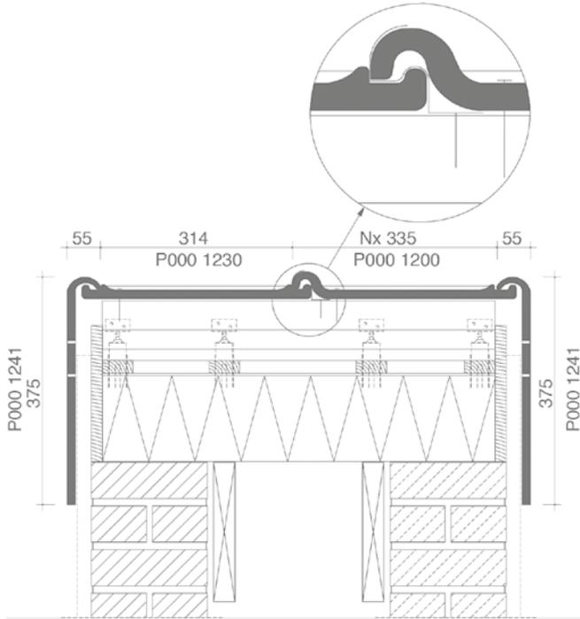
PLAN DE POSE TRANSVERSALE DE LA TOITURE
