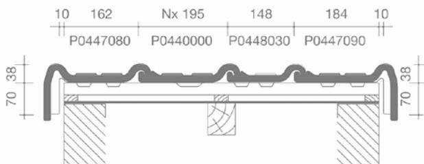
PLAN DE POSE LONGITUDINALE DE LA TOITURE
