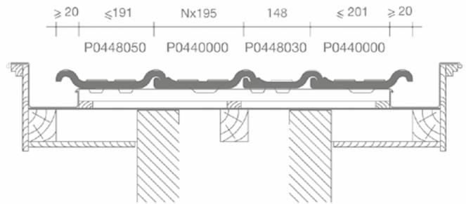
PLAN DE POSE TRANSVERSALE DE LA TOITURE
