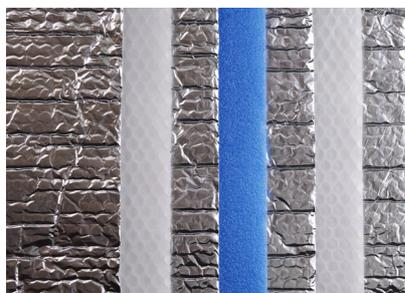
1. Une feuille d'aluminium pur de 30 microns traité contre l'oxydation
