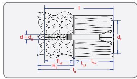
Determination of maximum thickness of insulation material:  $t_{fix} = L - t_{tol} - h_{ef}$  / Bepaling van de maximale dikte van isolatiemateriaal:  $t_{fix} = L - t_{tol} - h_{ef}$
