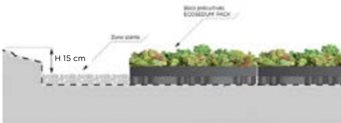
Système SEDUM + zone stérile en gravillons
